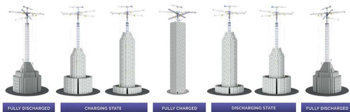
Obr. 2: Demonstrační systém gravitační baterie od Energy Vault v různých stupních nabití [4]
