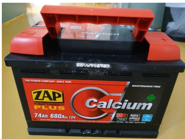
Obr. 1: Olověný akumulátor ZAP Plus 74 Ah určený pro zkušební metody.
