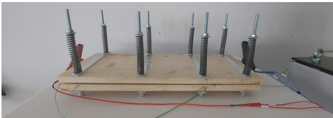
Obr. 2: Měření baterie stažené ve svorkách.
