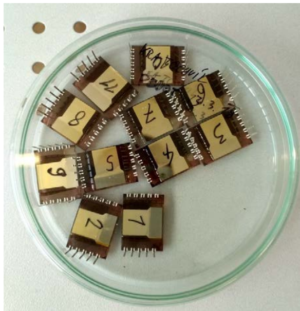
Obr. 1: Připravená série 11 perovskitových fotovoltaických článků s použitím kyseliny olejové jako pasivační vrstvy.
