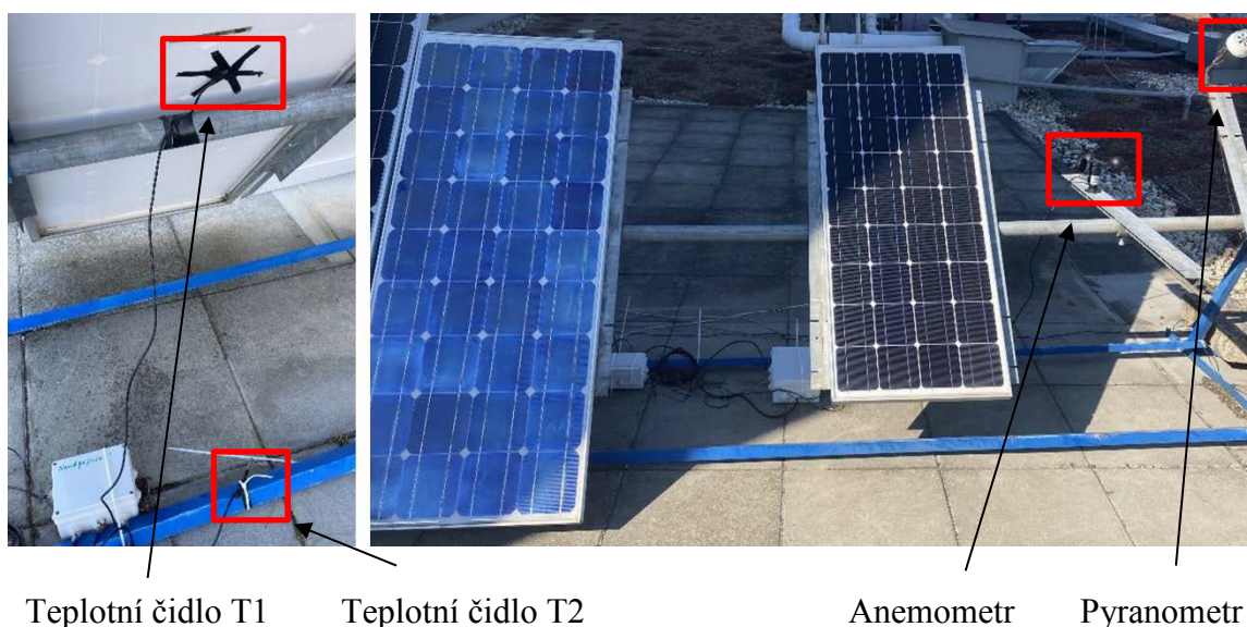
Obr. 1: Umístění teplotních čidel, anemometru a pyranometru.
