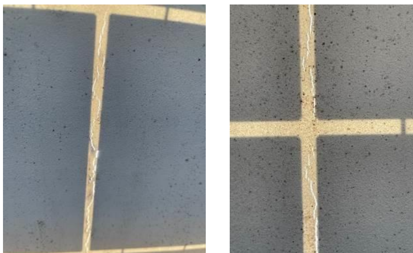
Obr. 4: Prasklá krycí zadní folie.
