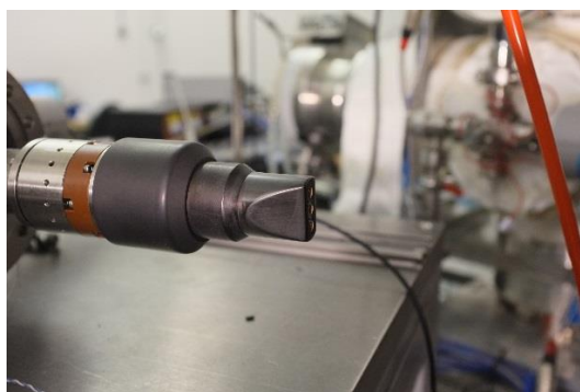
Obr. 1: Ball pen sonda Mgr Jiřího Adámka, Ph.D. ÚFP AV ČR.
